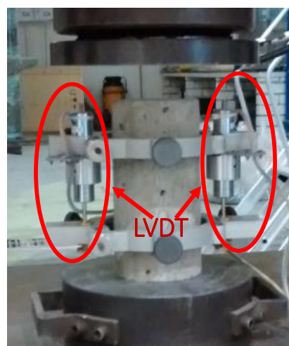
Figura 5.4.4. Esquema do ensaio de módulo de elasticidade.
