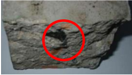
Figura 3.7.2.2: Superfície de ruptura de um corpo de prova de concreto com agregado reciclado (agregado reciclado rompido, em destaque).
