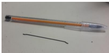
Figura 5.1.2.5. Fibra de aço utilizada no trabalho.
