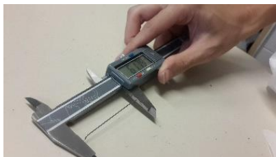
Figura 5.1.2.6. Verificação geométrica da fibra de aço.
