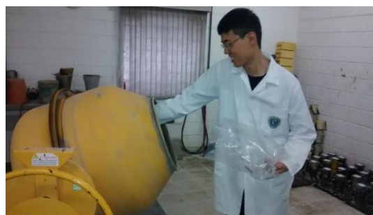
Figura 5.2.2.2. Adição das fibras de aço ao concreto.
