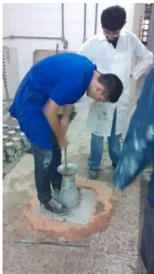
Figura 5.2.2.3. Execução do ensaio de abatimento de tronco de cone.
