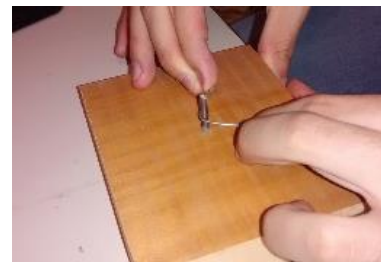
Figura 5.1.2.7. Ensaio de dobramento da fibra de aço.
