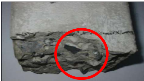
Figura 3.7.2.3: Superfície de ruptura de um corpo de prova de concreto com agregado natural (agregado natural íntegro, em destaque).
